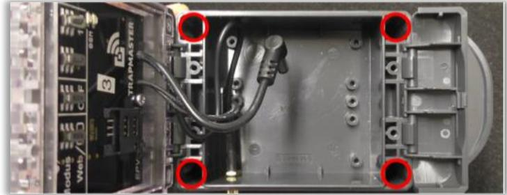
Um Unbefugten das Öffnen des Melders zu erschweren, kann der Deckel mit 2 Schrauben (3x20mm) gesichert werden.
