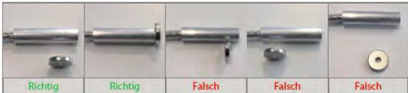
Befindet sich der Magnet nahe genug beim Näherungsschalter (berührungslos oder angeheftet), so schließt dieser. Bewegt sich der Magnet beim Schließen der Klappen vom Näherungsschalter weg, so löst der Melder Alarm aus.
