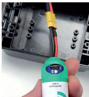
Der TRAPMASTER wird inklusive Spezial-Akkus ausgeliefert. Der Akku ist bei Auslieferung vorgeladen. Eine komplette Ladung vor der ersten Inbetriebnahme ist aber zu empfehlen.
