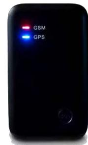
Der MU.201G2/G3 wird bei Unterschreitung von 3,45 Volt automatisch ausgeschaltet, dadurch wird ein Tiefentladen des Akkus verhindert.
