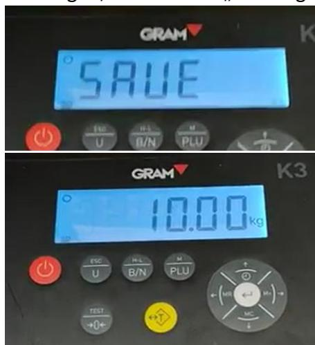
14. Das Referenzgewicht von der Waage nehmen und die Waage durch langes Drücken des Ausschaltknopfs ausschalten
